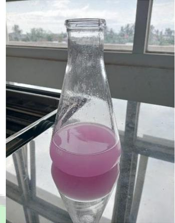
**Gambar 8** Hasil pengujian ALB minyak jelantah
