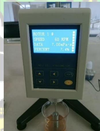
**Gambar 17** pengukuran viskositas
