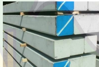
Gambar 4.51 : Minipile Bentuk penampang bujur sangkar
