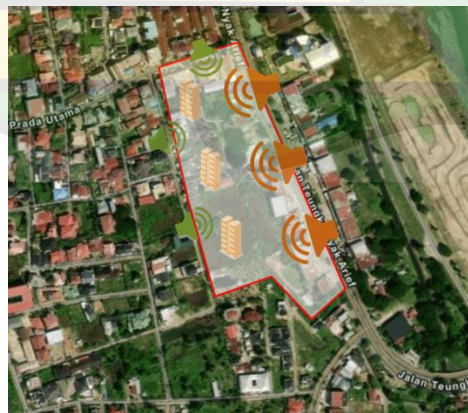
Gambar 4.32 : meletakkan bangunan jauh dari sumber kebisingan.
