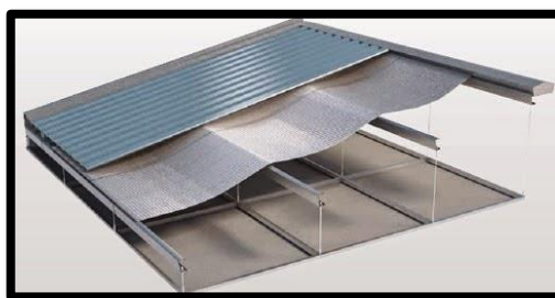
Gambar 3. 2 Ilustrasi Atap Menggunakan Pemantul Panas Sumber: peredam-panas-terbaik.blogspot.com
