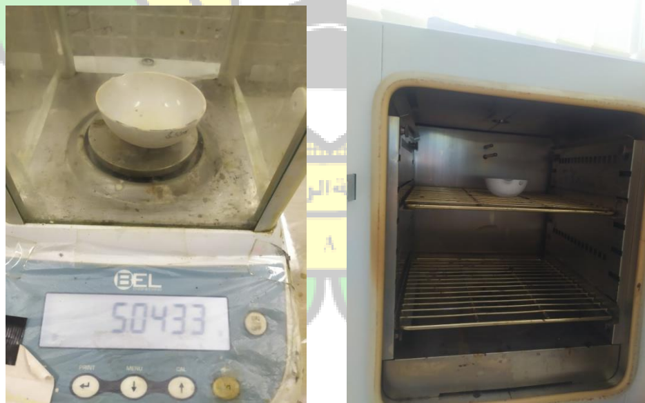
Gambar 4.12 Uji Kadar Air
