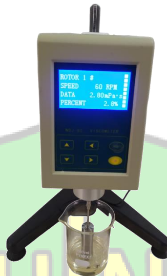
Gambar 4.11 Uji Viskositas Biodiesel
