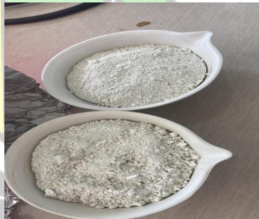
Gambar 4. Cangkang setelah di tanur
