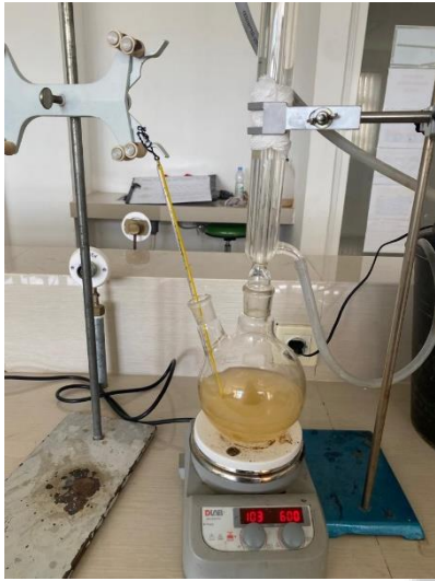
Gambar 13. Esterifikasi Minyak Plieuk U
