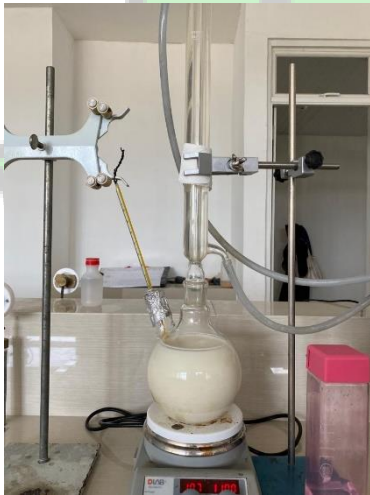
Gambar 15. Transferifikasi Minyak Plieuk U
