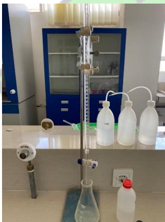
Gambar 23. Uji Bilangan Asam
