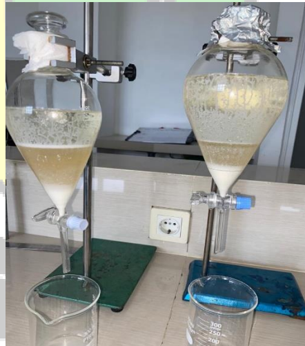
Gambar 16. Hasil Transferifikasi Yang Sudah Didiamkan 1 Malam
