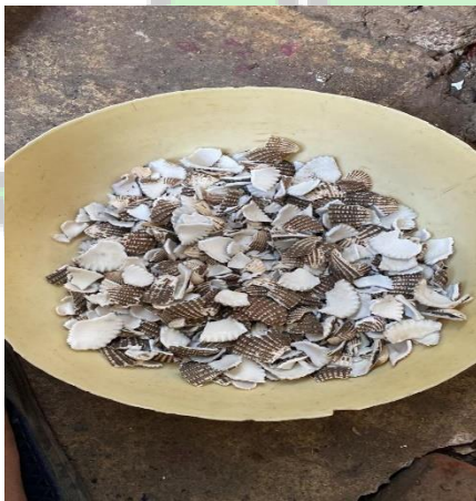
Gambar 3. Cangkang yang telah dihancurkan dan dioven
