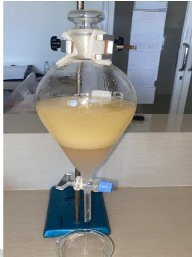
Gambar 14. Pencucian Dengan Aquades
