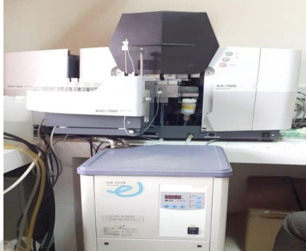
Gambar II. 2 Spektrofotometer Serapan Atom Sumber : Dokumen Pribadi
