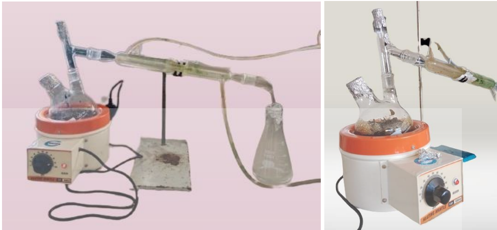
Gambar 5.3 Proses destilasi minyak atsiri Ruku-ruku dengan destilasi air
