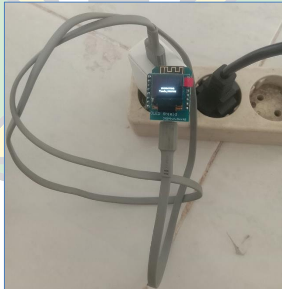
Gambar 4.32 Menghubungkan fluxion portable pada listrik
