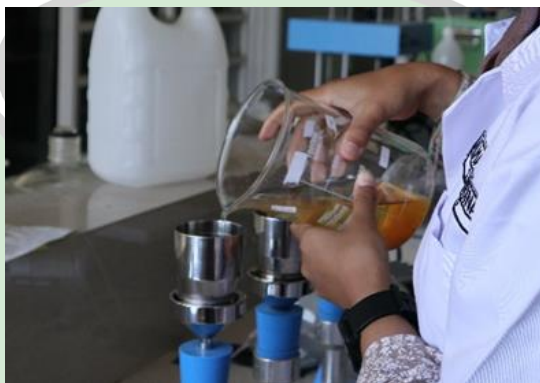
Gambar 3.8 Penyaringan mikroplastik menggunakan pompa vakum
