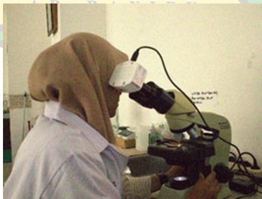
Gambar 3.9 Identifikasi jumlah, bentuk dan warna mikroplastik dengan mikroskop
