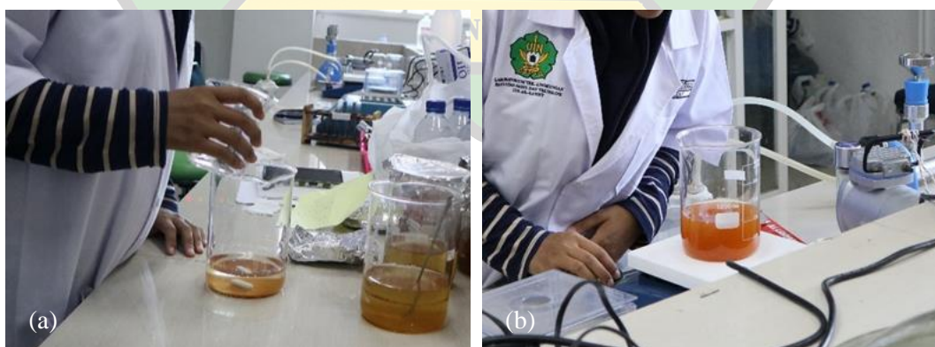
Gambar 3.7 (a) Penambahan NaCl 200 mL; (b) Proses pengadukan larutan dengan magnetic stirrer
