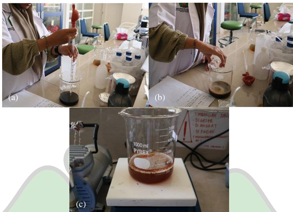
Gambar 3.6 (a) Penambahan \text{H}_2\text{O}_2 pada sampel; (b) Proses penambahan 20 mL \text{FeSO}_4 ; (c) Proses pemanasan dengan hot plate
