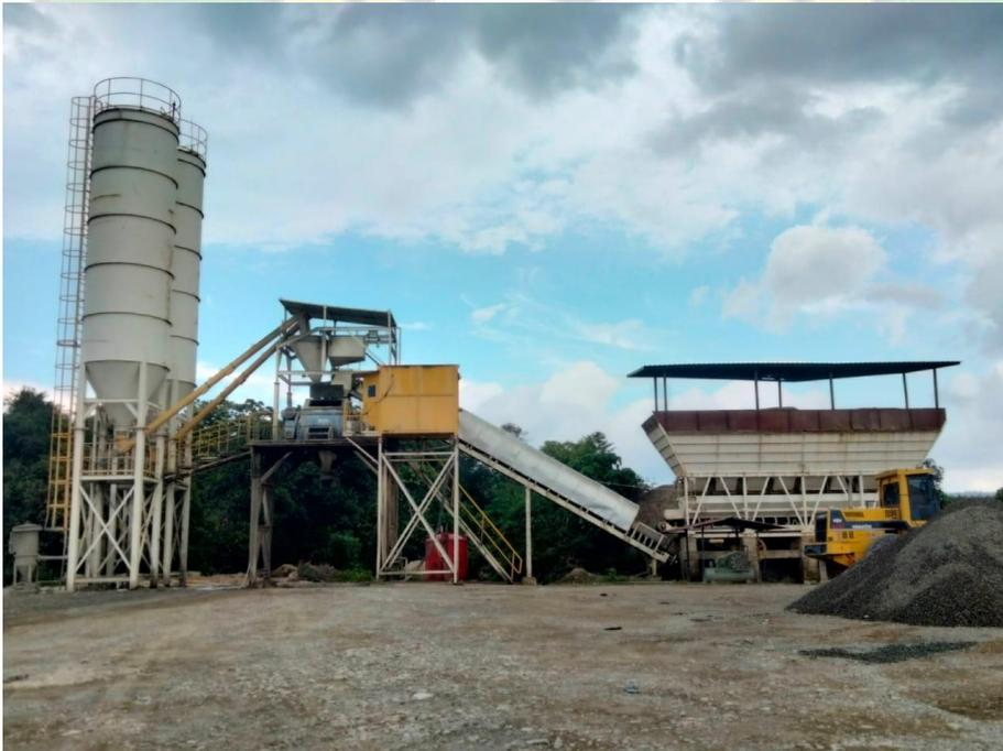
*Gambar 4 Batching Plant (Tempat Produksi Beton Ready Mix)*
