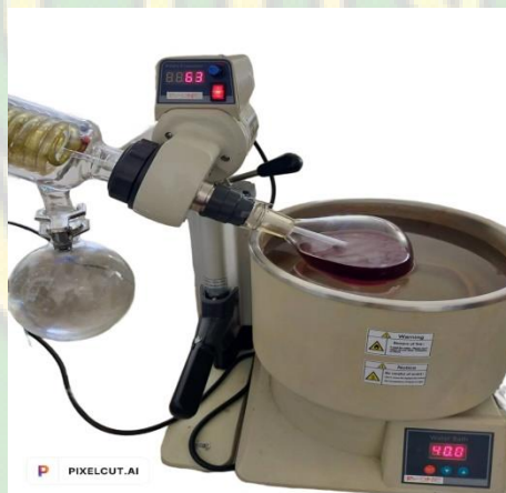
Gambar IV.1 Proses dipekatkan ekstrak buah bit
