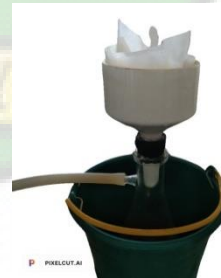
3. Disaring menggunakan vakum
