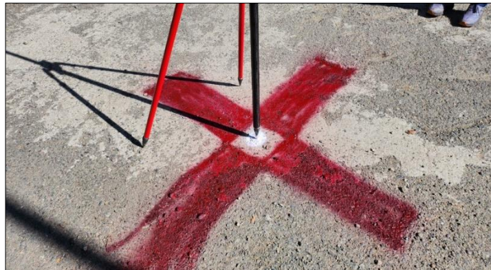
Gambar 2.5 Premark Titik Kontrol Tanah Media Piloc (Sumber: Dokumentasi)
