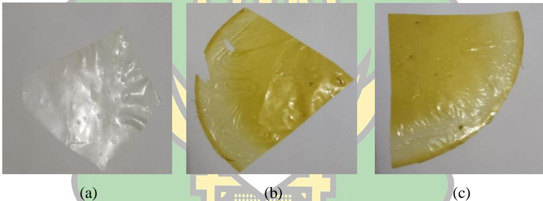
Gambar IV.1 Membran kitosan dengan variasi ekstrak etanol mamon ungu (a) membran kitosan (b) membran kitosan 0,3 ml ekstrak etanol mamon ungu, dan (c) membran kitosan 0,6 ml ekstrak etanol mamon ungu.
