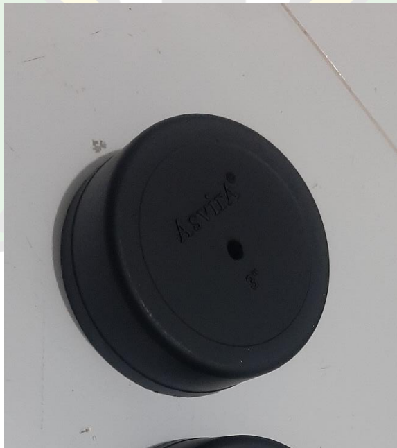
Gambar 3. 3 Melubangi Tutup Pipa
