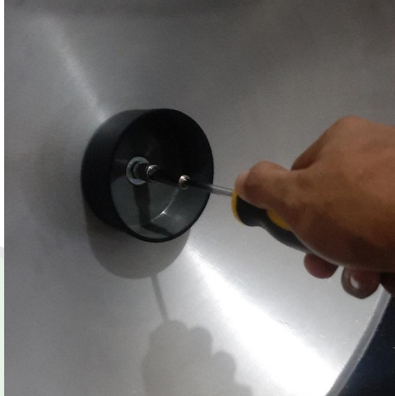
Gambar 3. 4 Memasang Tutup Pipa pada Wajan
