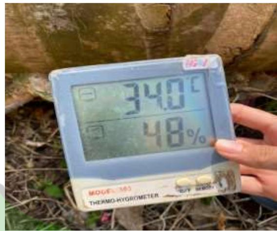
Mengukur kelembapan dan suhu udara
