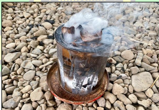
Gambar 3. 6 Proses Karbonisasi Manual Kulit Buah Kakao
