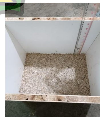
Proses pembuatan box panel ampas tebu
