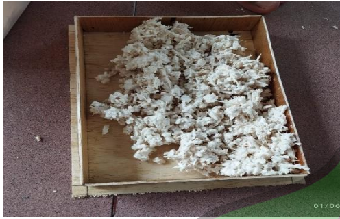
Memasukkan campuran ampas tebu dan lem fox pada cetakan papan panel
