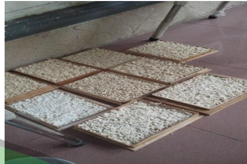
Memasukkan campuran ampas tebu dan lem fox pada cetakan papan panel
