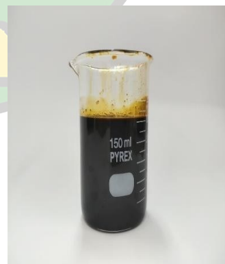
Gambar V.8 Ekstrak yang telah dipekatkan dengan rotary
