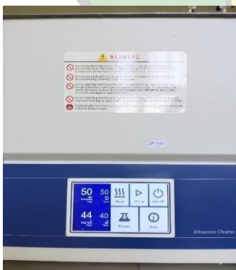
Gambar V.6 ekstraksi dengan suhu 40°C selama 50 menit
