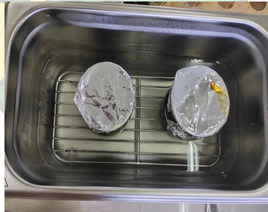
Gambar V.5 ekstraksi dengan metode sonikasi
