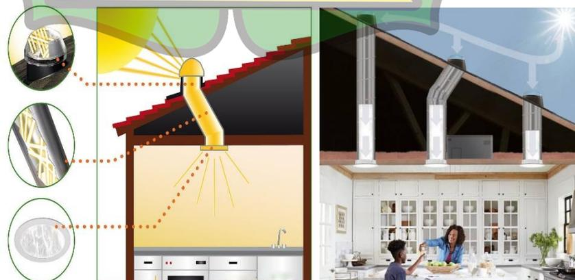
Gambar 4.13 *Solar Tube* pada Atap Bangunan
