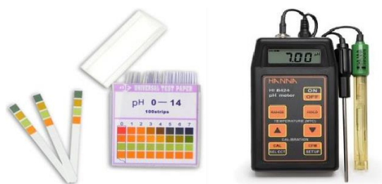
Gambar 2.1 Indikator Universal dan pH Meter (Sumber: Kimia, 2019)
