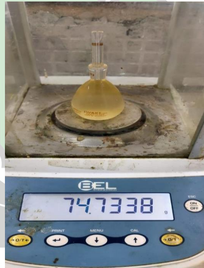
Gambar 15. Pengukuran densitas 3:1 (CaO/ZnCl 2 )
