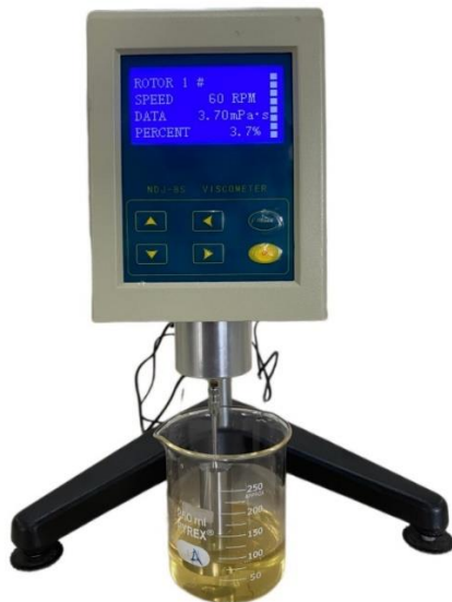
Gambar 19. Pengukuran viskositas 3:1 (CaO/ZnCl 2 )
