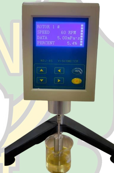
Gambar 20. Pengukuran viskositas 1:3 (CaO/ZnCl 2 )
