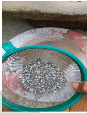
Gambar 2. Cangkang yang telah dihancurkan dan dioven
