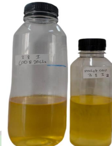
Gambar 18. Hasil biodiesel 3:1 (banyak CaO) dan 1:3 (banyak ZnCl 2 )
