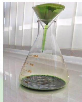
Gambar : Proses penyaringan dengan kertas saring
