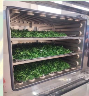
Gambar : proses pengeringan dengan oven
