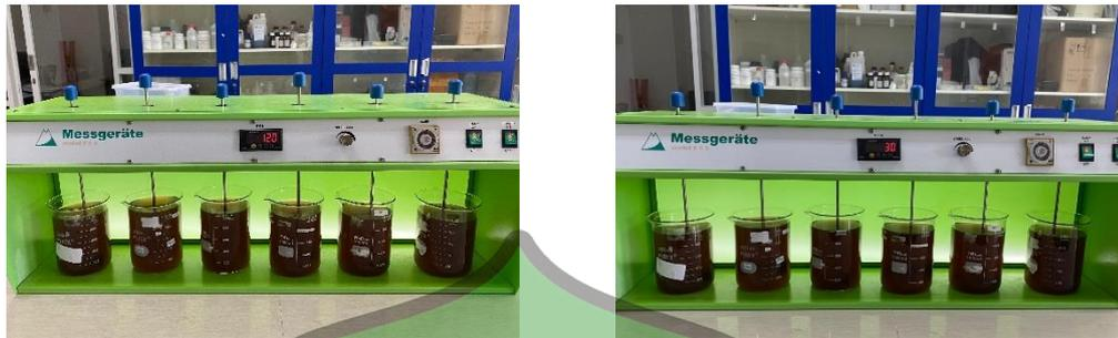
**Gambar 4.2** Proses pengadukan kecepatan 120 rpm dan pengadukan lambat 30 rpm dengan biokoagulan cangkang kerang tiram (*Magallana gigas*)
