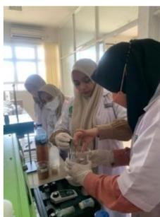
**Gambar 3.9** Pengukuran kekeruhan menggunakan turbidimeter
