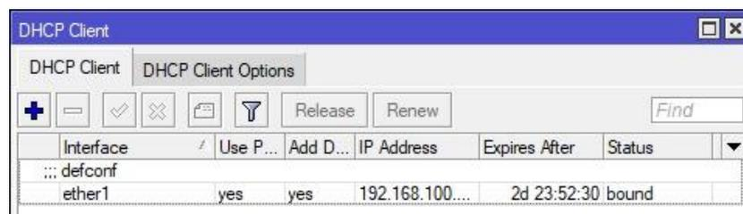
Gambar 3. Hasil Konfigurasi DHCP Client
