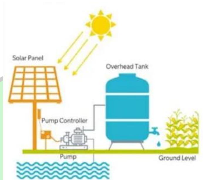
Gambar 3.4 Rancangan Miniatur Pengisian Tandon Air
