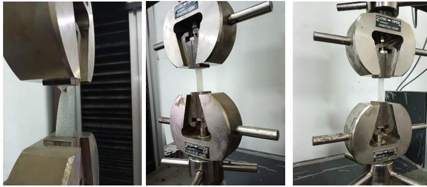
Gambar 2. 5 Alat uji kuat tarik dan elongasi
