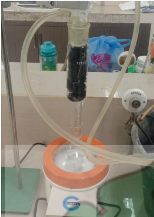
Gambar IV.3 Pengekstrakan biji sachu inchi dengan alat soklet
