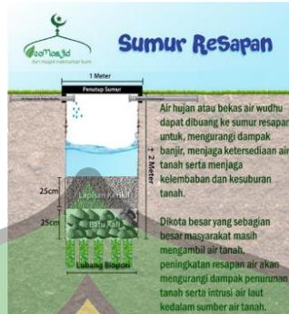
Gambar 2.9 Sumur Resapan
