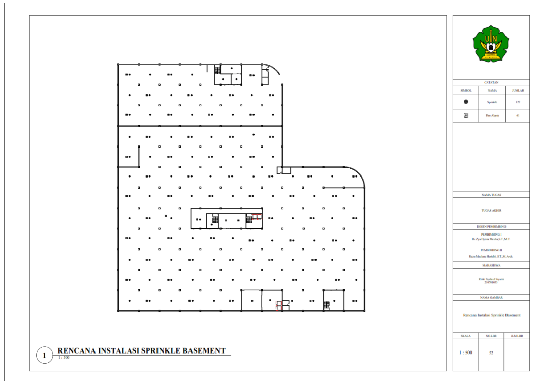
Gambar 6. 52. Rencana Instalasi Sprinkle Basement
