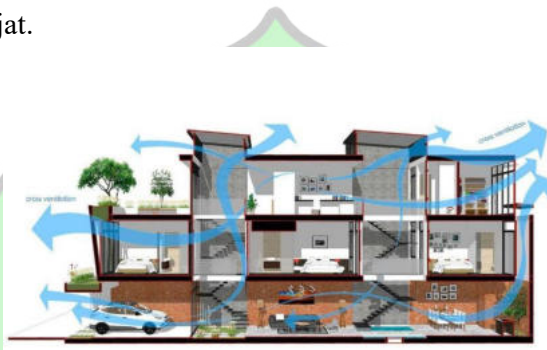
Gambar 4.40 Penghawaan alami dengan system Ventilasi Silang
