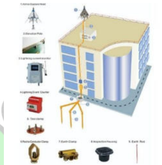
Gambar 5.29 Konsep Kerja Penangkal Petir ESE
