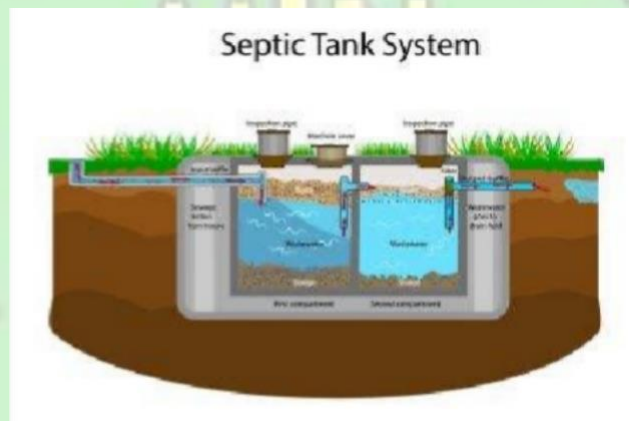
Gambar 5.51 Skema Sistem Jaringan Septic Tank (Sumber: Depositphotos)
