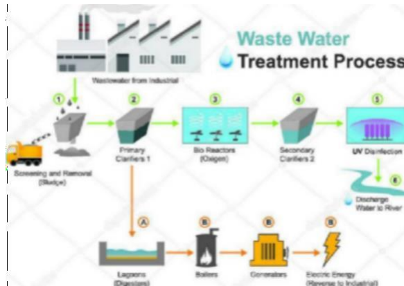
Gambar 5.52 Skema Sistem Jaringan WWTP (Sumber: Depositphotos)
