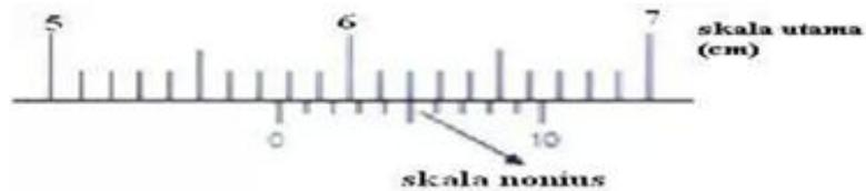
Gambar tersebut menunjukkan hasil pengukuran diameter tabung menggunakan jangka sorong. Berdasarkan gambar tersebut hasil yang benar adalah....
