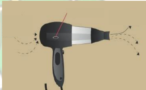
Gambar 2.10 konveksi pada hair dryer
