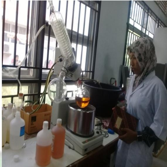
Proses Pemisahan Etanol dan Ekstrak Kulit Buah Rambai dengan alat *Rotary vacuum evaporator*
