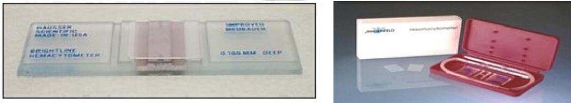
Gambar 3.1 Hemositometer *Improved Double Neubauer*
