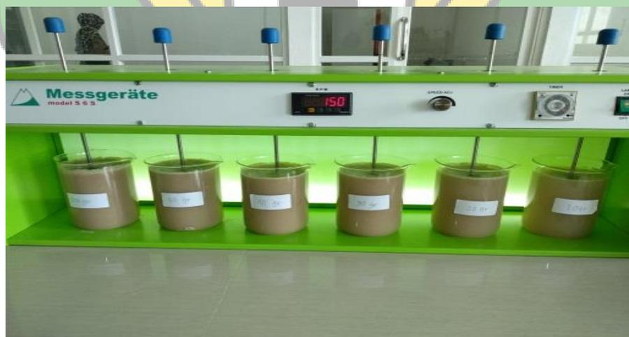
**Gambar 4.3** Proses Pengadukan Cepat menggunakan cangkang keong sawah dengan menggunakan *jar test*.
