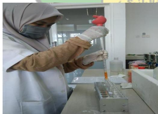
Proses pengujian COD dengan penambahan bahan kimia  $K_2Cr_2O_7$  dan  $H_2SO_4$  pada sampel uji.
