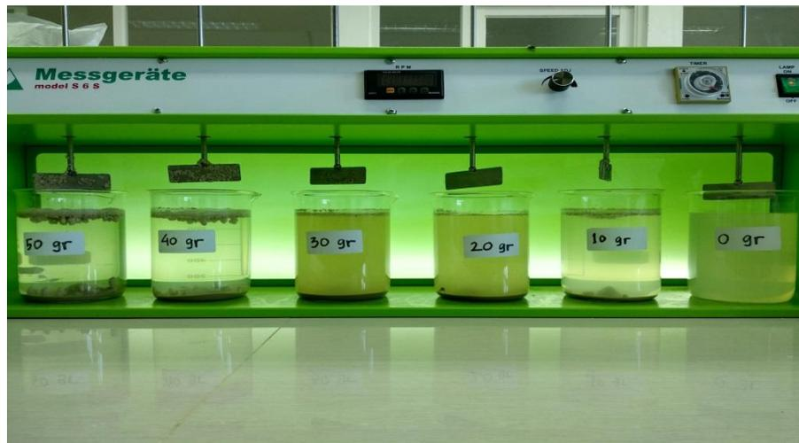
**Gambar 4.4** Proses Pengendapan koagulan cangkang keong sawah.
