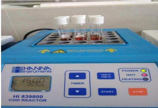
Proses pemanasan sampel uji pada alat COD reaktor.
