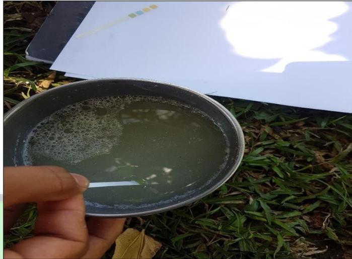
Gambar 1. Pengujian pH dilokasi Pengambilan Sampel/Sebelum Pengolahan
