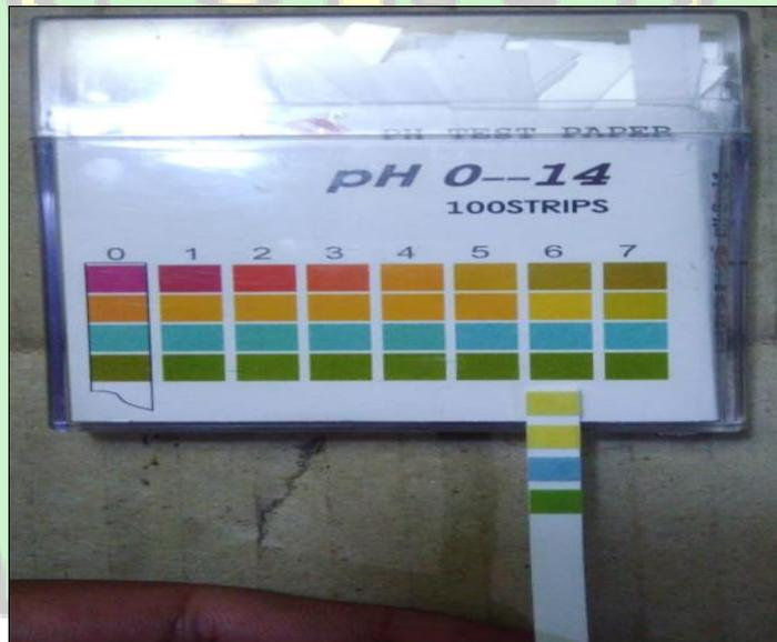
Gambar 4. Parameter pH Menunjukkan (6-7) Pengukuran dengan pH *Test Paper* (0-14) in *pandemic covid-19* setelah dilakukan Pengolahan pada Reaktor *Biofilter*
