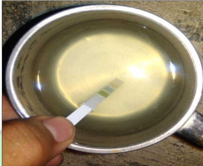
Gambar 3. Pengujian pH setelah Dilakukan Pengolahan pada Reaktor *Biofilter*
