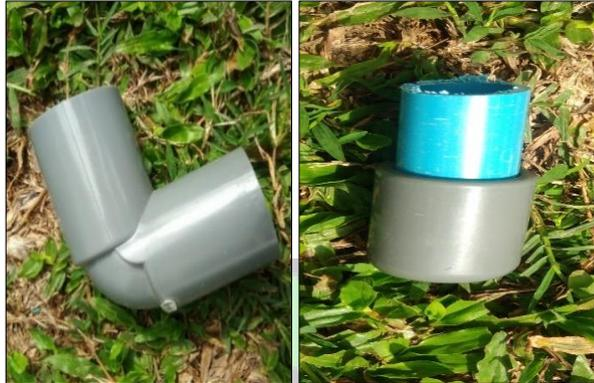
Gambar 3. Elbow 1 Inchi sebagai *Influent* dan Penutup pada *Efluent*
