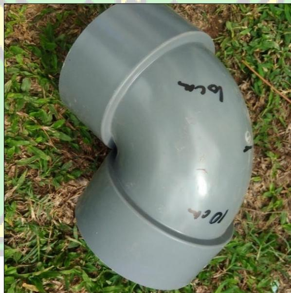
Gambar 2. *Elbow* 4 Inchi sebagai Sambungan pada *Efluent*
