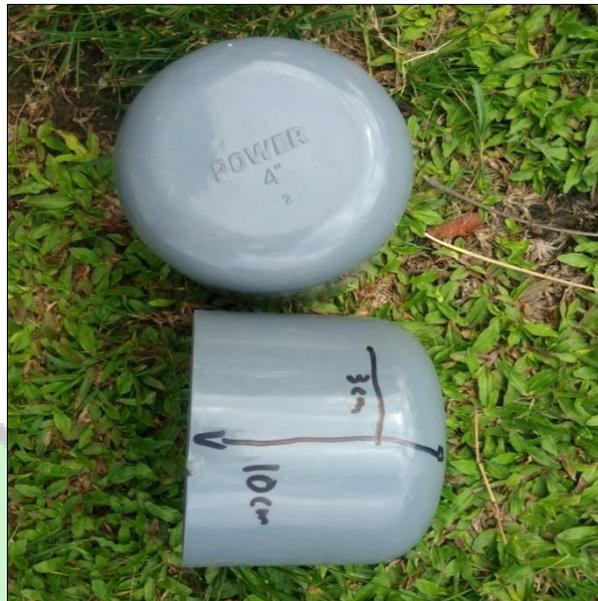
Gambar 1. Dob sebagai Penutup pada *Biofilter*
