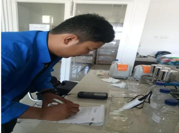
Pengujian pH pada air limbah cair domestik menggunakan multiparameter
