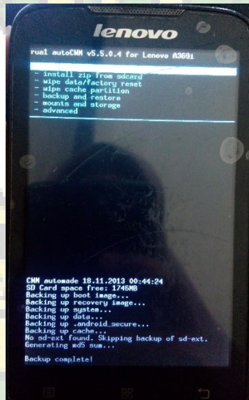
Gambar 4.9 Proses Backup data menggunakan CWM Recovery
