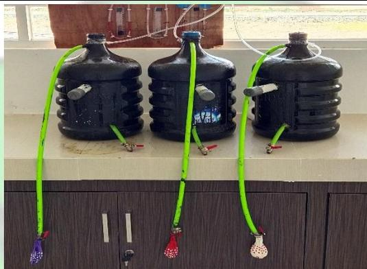
Digester anaerobik di laboratorium Teknik Lingkungan
