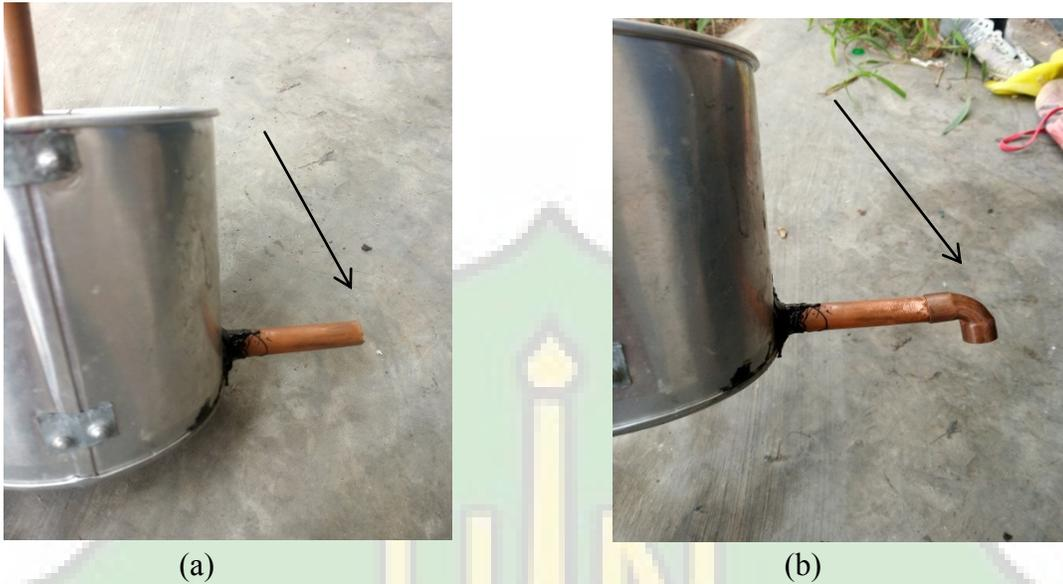
**Gambar 4.4** (a) desain awal pipa keluar asap cair dan (b) desain pipa keluar asap cair hasil revisi
