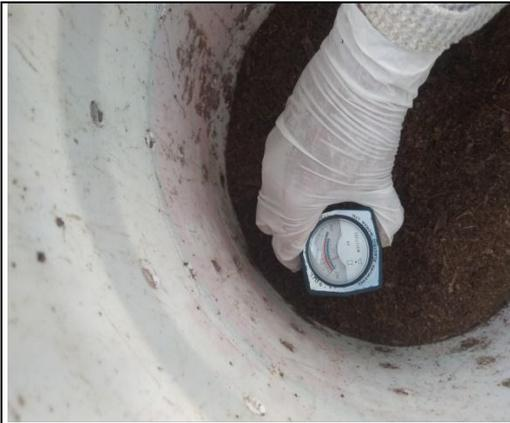
Gambar: Pengukuran Kadar Air
