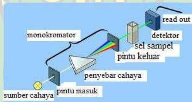
**Gambar 3. Metode Spektrofotometri UV-Vis**
