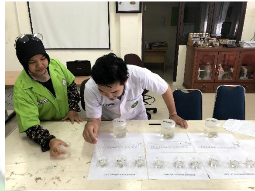
Foto : Proses pengenceran BTI dan perhitungan sampel larva Ae aegypti yang hendak di uji
