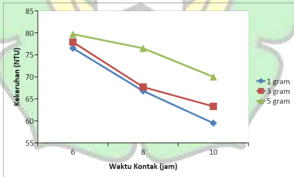
**Gambar 4.8** Grafik penurunan kekeruhan terhadap massa 1 gram, 3 gram dan 5 gram serta waktu kontak 6 jam, 8 jam dan 10 jam dengan kecepatan putar 150 rpm.
