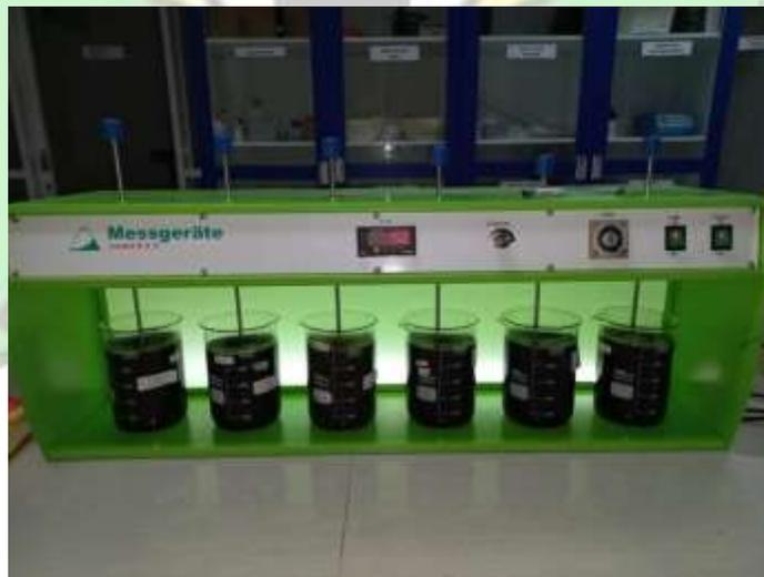
**Gambar 3.5** Proses adsorpsi menggunakan flokulator
