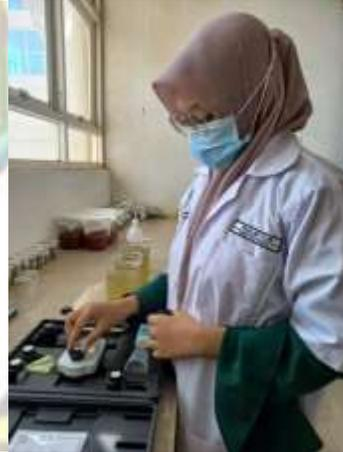
Proses pencampuran  $H_2SO_4$ ,  $K_2Cr_2O_7$  dan sampel limbah cair domestik
