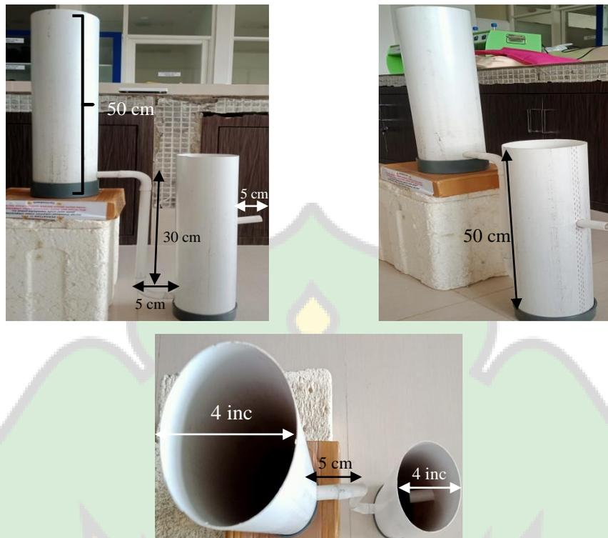
**Gambar 3.4** Reaktor filtrasi a). Tampak samping; b). Tampak depan; c). Tampak atas.
