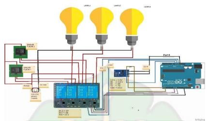
Gambar 3.6 Rangkaian Keseluruhan Instalasi Penerangan berbasis *Internet of Things* (IOT)
