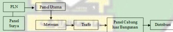
**Gambar 5.26** Sistem Instalasi Listrik
