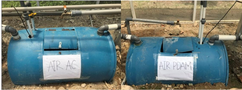
G. Menampung air AC dan air PDAM pada bak induk
