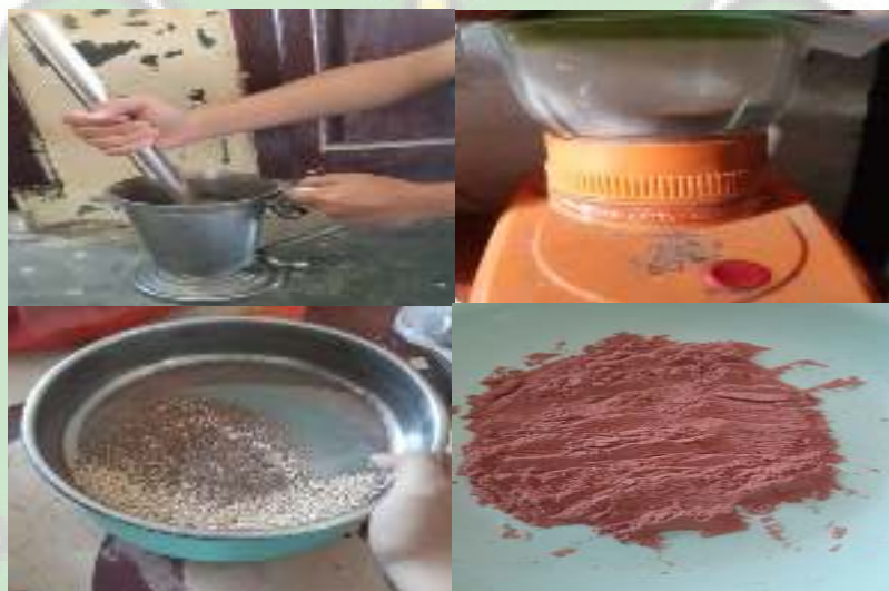
Gambar 4.1 Pembuatan Koagulan Alami Serbuk Biji Asam jawa untuk Proses Koagulasi-Flokulasi
