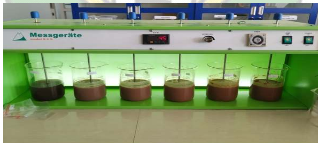
Gambar 4.3 Proses Pengadukan Lambat menggunakan serbuk biji asam jawa dengan menggunakan jar test (Sumber: Dokumen Pribadi, 2021)
