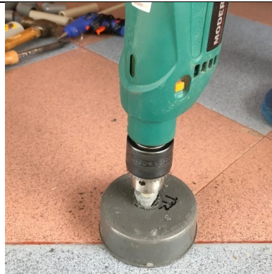
Proses pembuatan lubang pada dop PVC 3 inch
