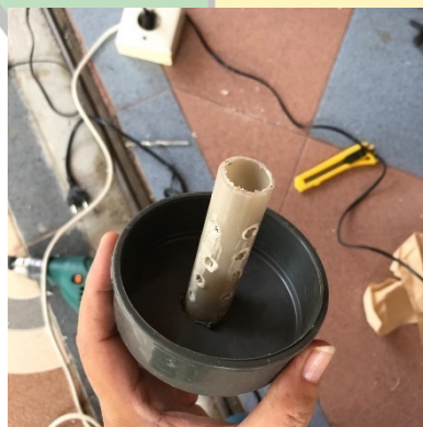
Yang telah diberi lubang kecil- kecil pada pipa
